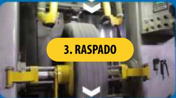
Con la raspadora se retira la banda de rodamiento desgastada respetando los perfiles y espesores recomendados por los fabricantes, a fin de obtener una precisa geometría y textura de la superficie raspada, permitiendo la colocación de una nueva banda de rodamiento.
