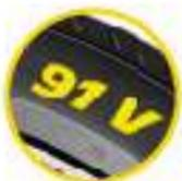
\* Luego se muestra el **índice de carga y velocidad**: el número es el de carga y la letra el de velocidad, estos se definen según las tablas de cada fabricante.
