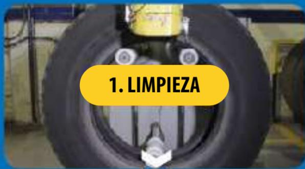
En la primera etapa la máquina de limpieza retira todos los residuos del flanco de la carcasa, eso es fundamental para minimizar la contaminación en las siguientes etapas del proceso.
