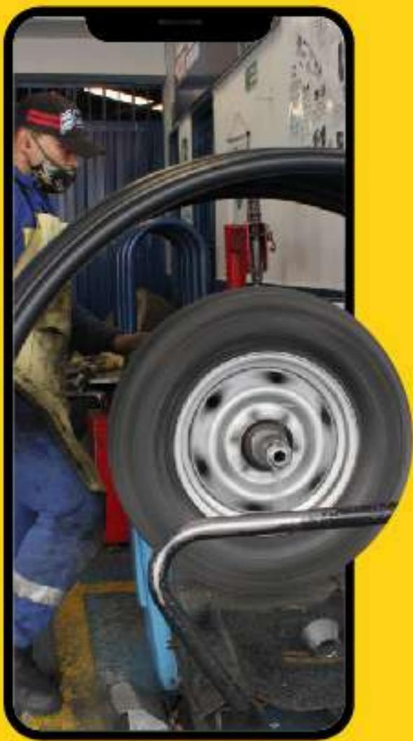
En el proceso de balanceo vamos a validar el rodamiento de la llanta. Como toda pieza mecánica, sufre desgastes y recordemos que es el primer contacto contra el suelo por lo que va a sufrir la absorción de irregularidades del camino como huecos o baches, o el peso. Eso la lleva a tener mucha susceptibilidad de deformaciones y en el balanceo vamos a validar simplemente los dos tipos de alabeos o movimientos tanto laterales como horizontales que puede tener la llanta.
