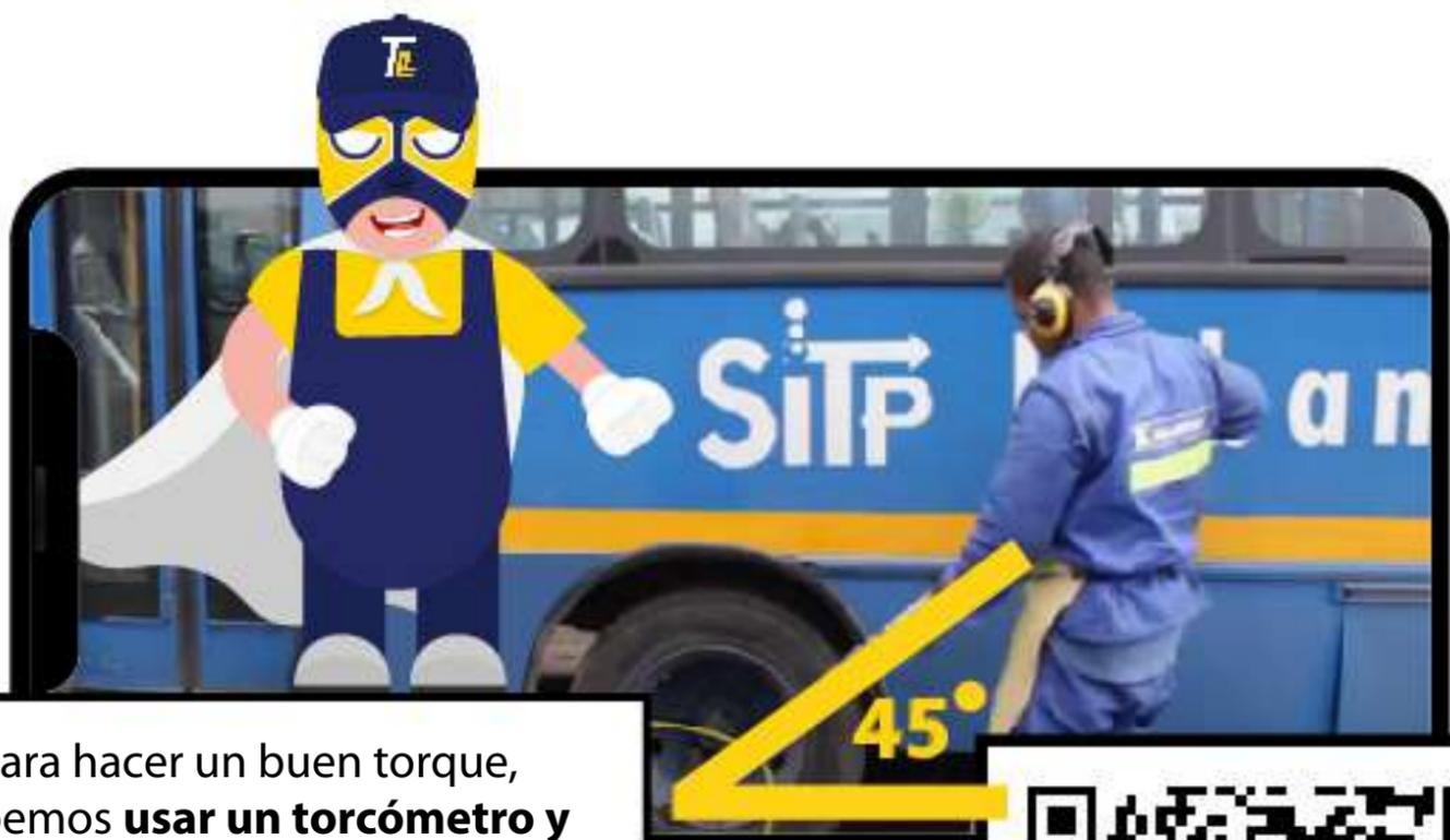
Para hacer un buen torqueo, debemos **usar un torcómetro y apretar a la presión que defina el fabricante del vehículo o del rin,** o en su defecto la definida por el departamento técnico.
